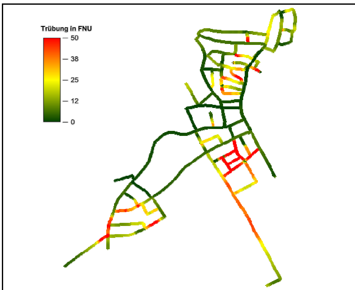
Obr. 3. Znázornění stavu usazenin v síti spojením údajů o zákalu získaných v rámci odkalování a geografických údajů o síti Legenda: Trübung in FNU = zákal v jednotkách zákalu
