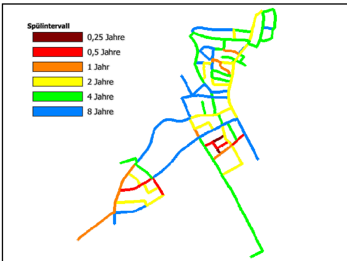
Obr. 5. Propočtené intervaly odkalování s ohledem na skutečný stav sítě odpovídající rychlosti akumulace usazenin Legenda: Spülintervall=interval odkalování (proplachování) sítě; Jahr/e=rok/roky
